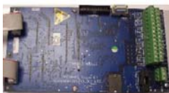
AIR30690 Grundplatine für Stratos-HSSD 2 Steuereinheit
