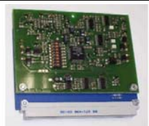
BST30702 Apollo XP95 Schnittstellenkarte nichtanaloger Typ
