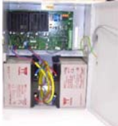
BST30102 Netzteil 24V / 1 A im Gehäuse inkl. 2 Akkus 12 V / 24 Ah wie BST30101, jedoch - Max. Dauerstromentnahme 1 A - Abmessungen: B 300 x H 380 x T 200 mm - VdS-Anerkennung G 299009
