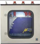
BST30407 Umgehäuse Stratos Micra 100 Schutzgehäuse mit Sichtfenster incl. 2 Eingangsverschraubungen und 1 Ausgangsverschraubung für das Ansaugrohr. • Material: GFK • Abmessungen: H=400 x B=400 x T=200 • Schutzart: IP 56
